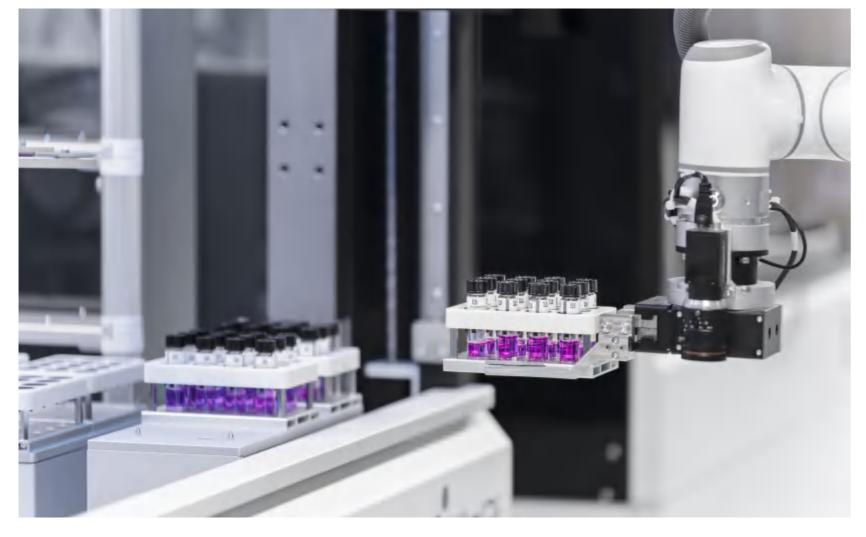
在系统指挥调度下,物流机器人正在运送实验试剂。晶泰科技供图。
