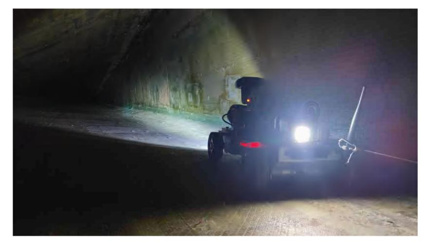
KIWI 机器人正在风机叶片内部执行内检。扩博智能供图。
