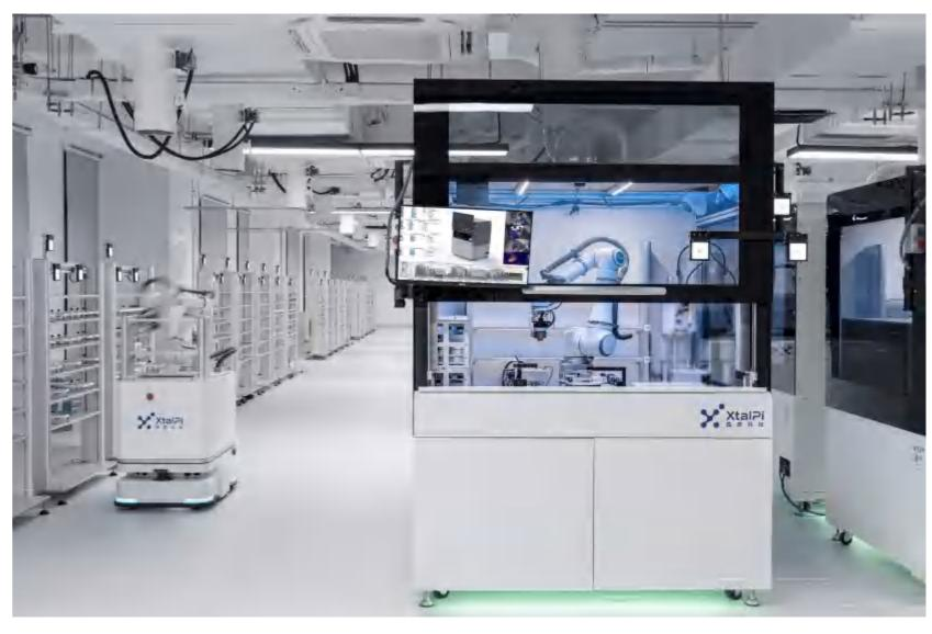
实验室里的机器人工作站与 AGV 小车相互协作,7×24 小时不停歇。晶泰科技供图。
