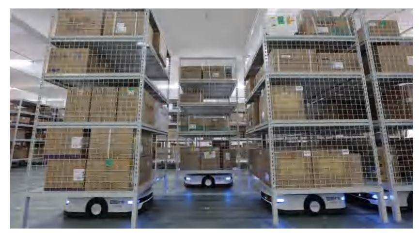
旷视 Matrix8 Handling 系统的 AMR+ 四向车机器人。 旷视科技供图。
